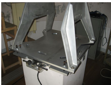
図 1.5: 極軸調整プレート。写真手前に見えるネジが水平調整ネジでプレートに垂直に立っているのが高度調整ネジである。
